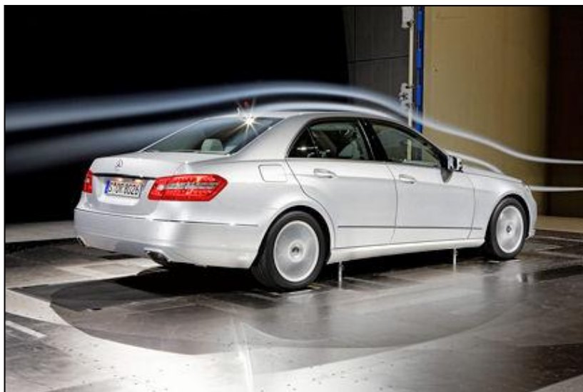
Figure 1 . Soufflerie automobile visualisation de l'écoulement
